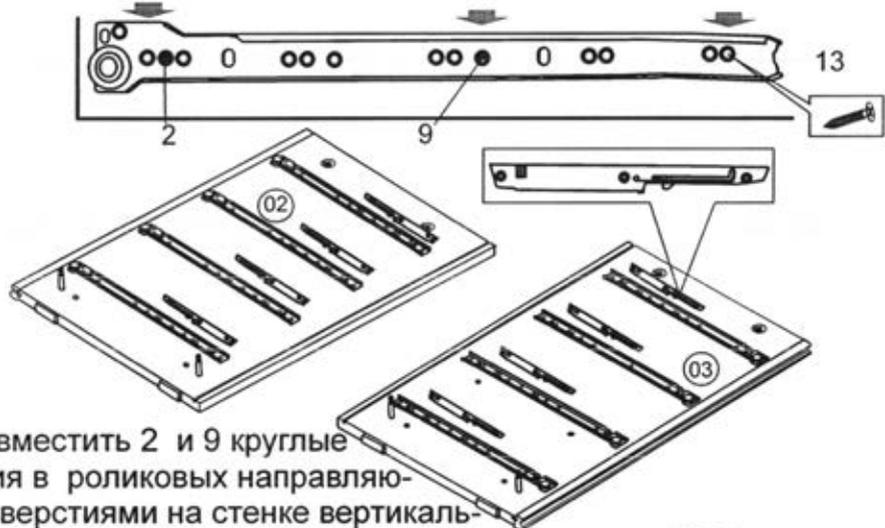
Совместить 2 и 9 круглые отверстия в роликовых направляющих с отверстиями на стенке вертикальной 02. Крепить направляющие к стенке вертикальной 02 на винты 6,3x10. В 13 отверстие установить шуруп 3,5x13. Аналогично оборудовать стенку вертикальную 03. На стенки вертикальные 02 и 03 установить демпферы, совместив отверстия на демпферах с отверстиями на стенке вертикальной, закрепить на шурупы 3,5x18.
