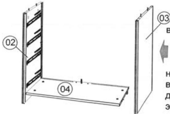
Приставить стенку вертикальную 03 соединительными винтами к отверстиям стенки горизонтальной 04, обеспечив входение соединительных винтов и шкантов в отверстия сопрягаемых деталей. и зафиксировать на эксцентриковую стяжку.
