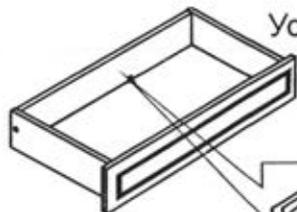
Установить переднюю стенку ящика и зафиксировать на эксцентриковую стяжку. Донья ящиков крепить к ящику на держатели задней стенки. *Аналогично собрать остальные ящики.*
