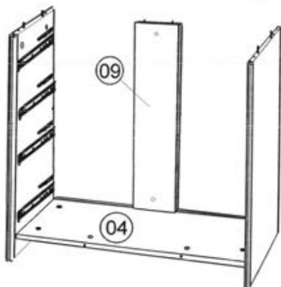
Стенку жесткости 09 установить на соединительный винт стенки 04, обеспечив входение шкантов стенки 09 в отверстия на стенке 04. Крепить стенку 09 к стенке 04 на эксцентриковую стяжку.
