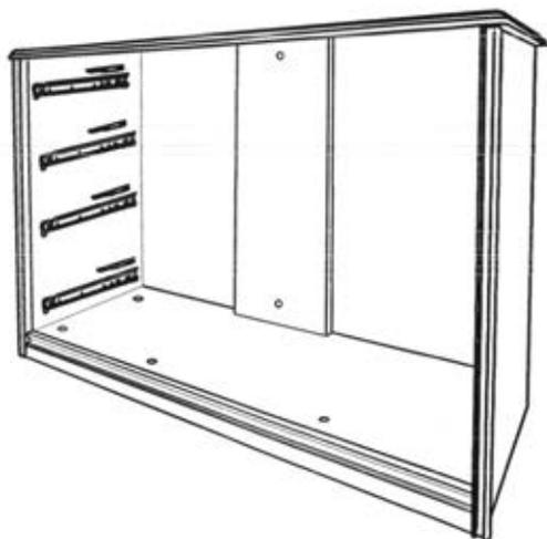
Установить крышку 01 на собранный каркас комода, обеспечив входение фурнитуры в отверстия сопрягаемых деталей и зафиксировать на эксцентриковую стяжку. Обратит особое внимание, чтобы задние стенки 06 вошли в паз крышки 01.
