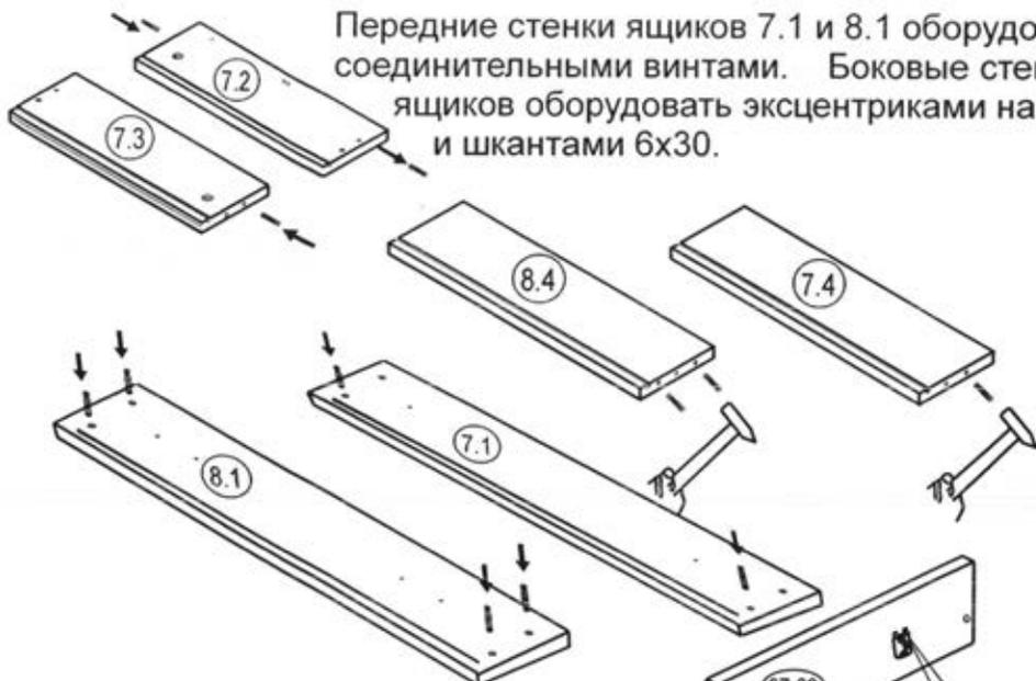
Боковые стенки ящиков 07.02 07.03 08.02 и 08.03 с внешней стороны по имеющимся наклкам оборудовать демферами и зафиксировать на шурупы 3.5x13.
