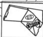
Передние стенки ящиков 7.1 и 8.1 оборудовать соединительными винтами. Боковые стенки ящиков оборудовать эксцентриками на 16 и шкантами 6x30.
