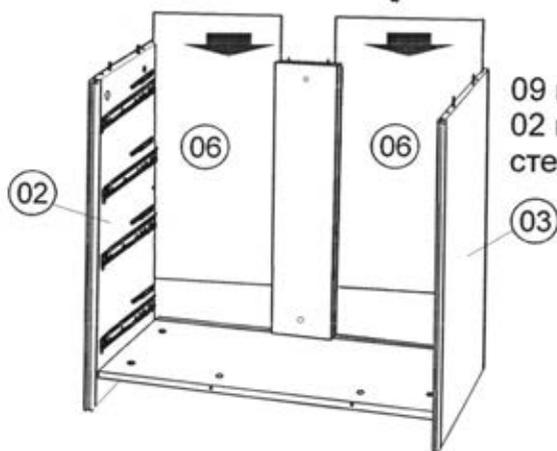
В пазы стенки жесткости 09 и вертикальных стенок 02 и 03 установить задние стенки 06.
