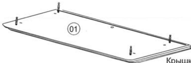
Крышку 01 оборудовать соединительными винтами.
