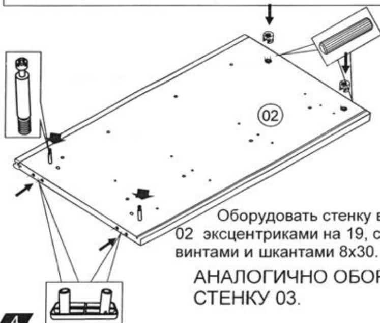
Оборудовать стенку вертикальную 02 эксцентриками на 19, соединительными винтами и шкантами 8х30.
