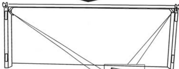
Установить комод задней стенкой вниз. Цоколь 05 соединительным винтом приставить к отверстию в стенке горизонтальной 04, обеспечив входение соединительного винта цоколя 05 в отверстие на кромке стенки 04 и зафиксировать на эксцентриковую стяжку. Крепить цоколь 05 к вертикальным стенкам 02 и 03 на мебельные уголки при помощи саморезов 4x13
